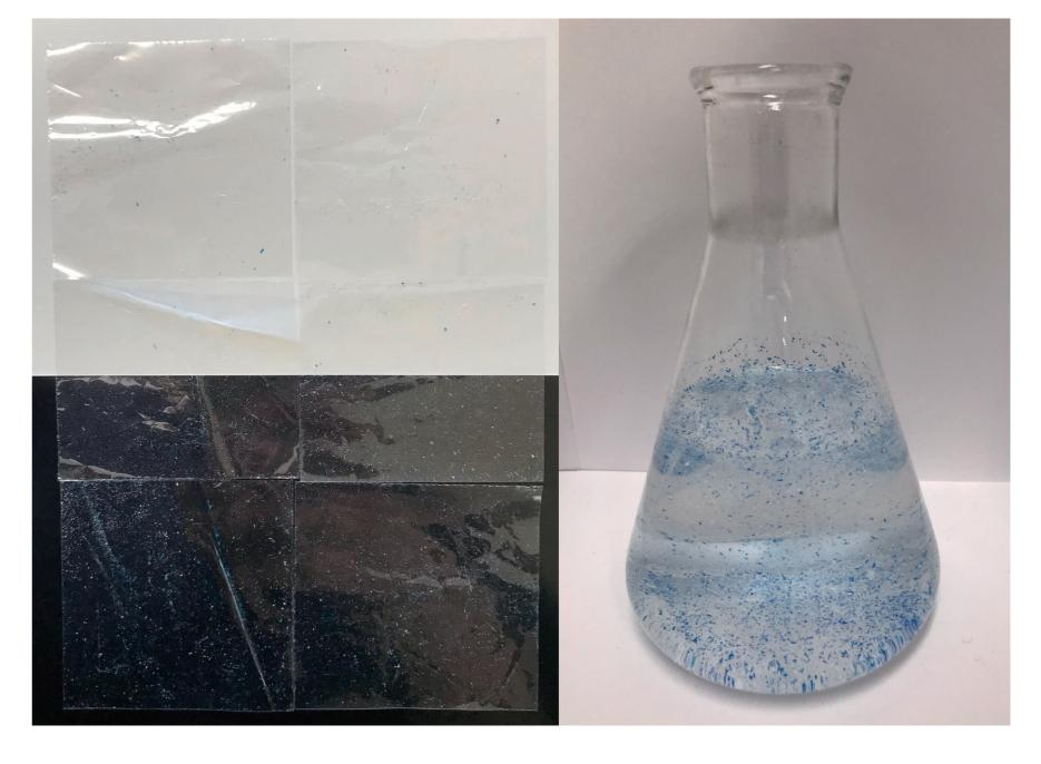
70℃、1.5wt% NaOH水溶液にて10分撹拌後水洗 (フィルム粉砕後の洗浄工程を想定)
